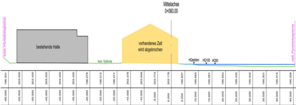
Abb. 3: Schnitt vorh. Gebäude mit HW-Wasserspiegellagen
